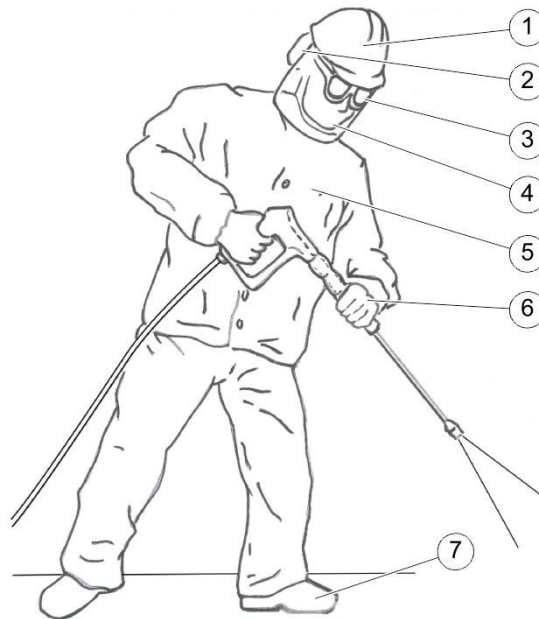
Abbildung 1: Schutzausrüstung für Hochdruckwasserstrahlarbeiten
