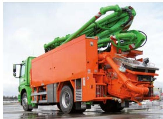
Autobetonpumpe mit Sanierausstattung
