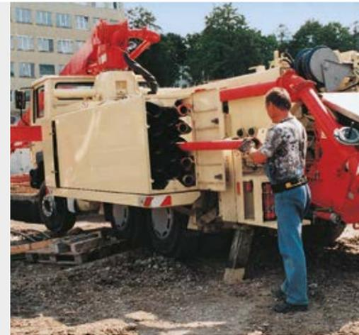
Zur einfachen Handhabung der Rohre und Schläuche gibt es ein hydraulisch absenkbares Magazin (Option, nur in Verbindung mit einem Radstand von 4200 mm)
