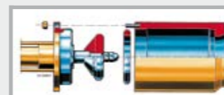
Fácil sustitución de las válvulas sin necesidad de desmontar las tuberías
