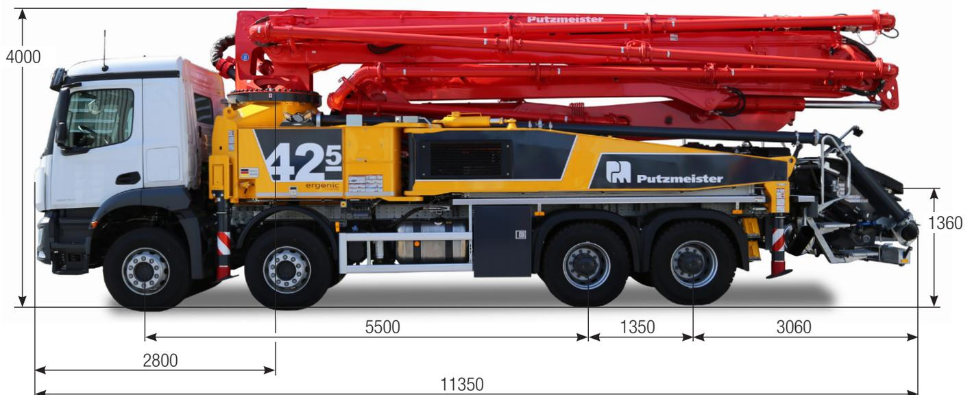
Nota: versione standard. Le dimensioni e il peso variano in base all'autocarro, al modello di pompa e all'attrezzatura.
