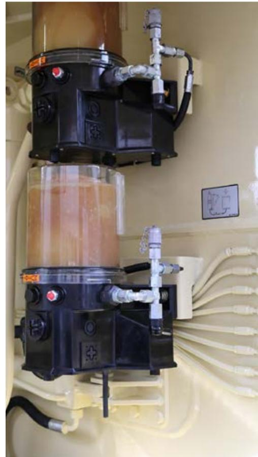
Graissage centralisé combiné : le graissage centralisé électrique pour la trémie, l'articulation A et le palier à quatre points est garant de l'optimisation de la durée de vie des composants fortement sollicités sans efforts supplémentaires. Le graissage centralisé en option de la flèche permet de réduire encore l'inspection quotidienne. Chacun sait que le temps, c'est de l'argent.
