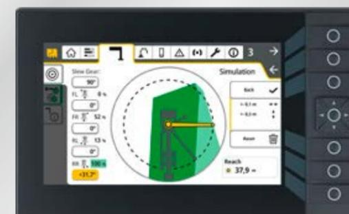
**La sécurité de stabilisation d'un seul coup d'œil** Des illustrations en temps réel faciles à comprendre, une manœuvre intuitive ainsi qu'une commande à distance rendent l'installation du chantier rapide et facile.
