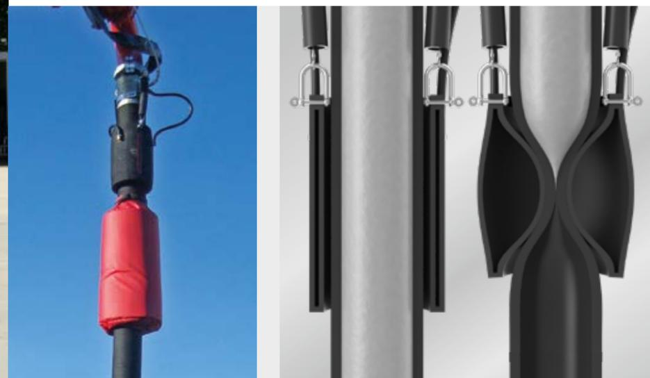
Saubere Sache: Optionales EQV (Endschlauchquetschventil) zum sauberen Verfahren des Endschlauchs auf der Baustelle. Kein Beton tropft aus dem Endschlauch.
