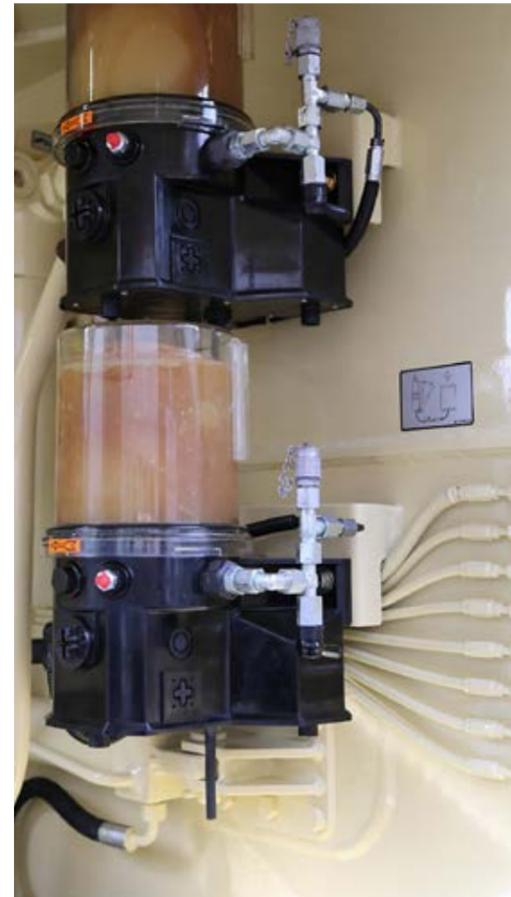
**Kombinierte Fettzentralschmierung:** Die elektrische Fettzentralschmierung für Trichter, A-Gelenk und Vierpunktlager sorgt dafür, dass die Lebensdauer der hoch beanspruchten Komponenten ohne zusätzlichen Arbeitsaufwand maximiert wird. Durch optionale Zentralschmierung am Mast kann die tägliche Inspektion weiter reduziert werden. Zeit ist ja bekanntlich Geld.
