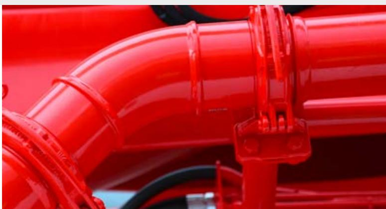
Wartungsfreie Bauteile mindern Betriebs- und Wartungskosten durch z.B. verschleißoptimierte Standardbögen mit langen Bunden für maximale Standzeiten der Förderleitung.
