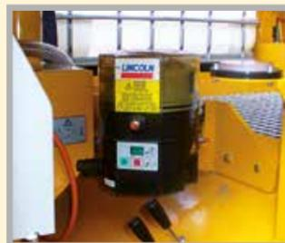
Zentralschmierung, Zentralschmierung für die korrekte Wartung der Maschine.
