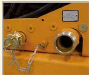
Schnellkupplungen für die Beton-, Zusatzmittel- und Druckluftversorgung. Ohne störende Schläuche an den Seiten der Maschine
