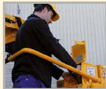
Manuell gesteuerte Hebel zum Betrieb des Raupenunterfahrzeugs
