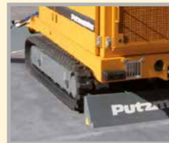
Hydraulisch betriebener, messerartiger Stabilisator für den sicheren Betrieb an steilen Steigungen
