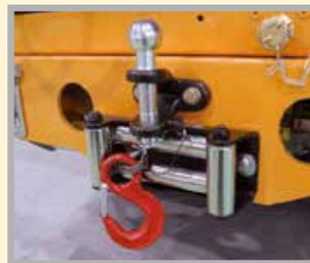
Anhängerkupplung mit einer Zugkraft von max 3.500 kg. Winde mit 50 m Seil und einer Zugkraft von 6.308 kg für sicheres Arbeiten an Steilhängen
