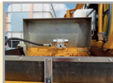
グリルにアジテーター、電気バイブレーター、RFIDセキュリティシステムを備えたホッパー。鋼またはポリマー繊維のポンピング。メンテナンスやクリーニングのために簡単かつ安全に開くことができます。
