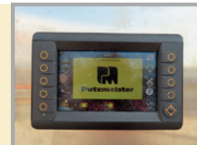
多言語カラーディスプレイによる非常に直感的な制御ソフトウェア。急結剤投与量の調整を可能にし、コンクリートの流量を示し、エラーをトラブルシューティングします
