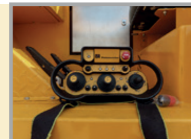
アームの動きを簡単かつ正確に管理するためのデュアル制御方式、ラジコンおよびケーブルリモートコントロール
