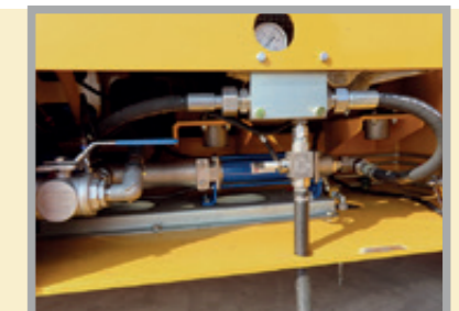
高品質の仕上がりを確保するための流量計付きスクリーユ添加剤ポンプ
