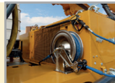
吹付面洗浄用のオプションのハイドロスケーリングシステム
