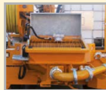
Su gran diámetro y larga carrera minimizan las pulsaciones y aumentan la vida útil de los elementos de desgaste de la bomba de hormigón
