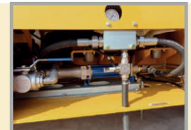
Zusatzmittelschneckenpumpe mit Durchflussmesser zur Gewährleistung einer hochwertigen Verarbeitung
