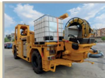
Betonpumpe von Putzmeister mit großem Durchmesser und langem Hub zur Minimierung der Kolbenhöhe und Erhöhung der Lebensdauer der Verschleißteile.
