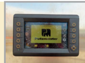
Intuitive Steuerungssoftware über mehrsprachiges Farbdisplay. Ermöglicht die Einstellung der Zusatzmitteldosierung, die Anzeige der Betondurchflussrate und die Fehlerdiagnose
