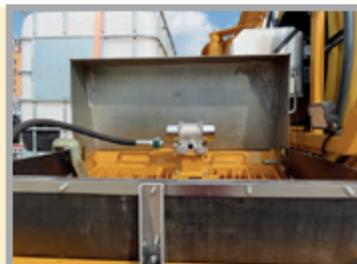
Trichter mit Rührwerk, elektrischem Rüttler und RFID-Sicherheitssystem im Gitter. Pumpen von Stahl- oder Polymerfasern. Einfaches und sicheres Öffnen für Wartung und Reinigung.
