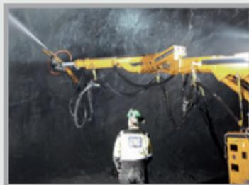
Optionales Hydroscaling-System für die Oberflächenreinigung
