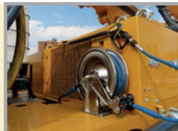
Eingebautes Reinigungssystem für Diesel- und Elektrobetrieb
