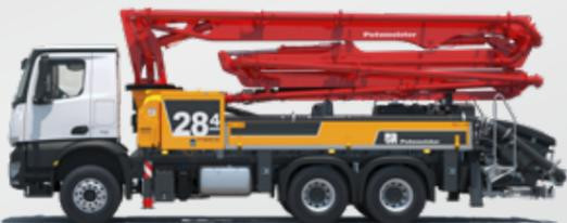
La **M28** aux multiples talents est une machine pour tous types de travaux. Des bâtiments résidentiels aux chantiers à l'intérieur des bâtiments, en passant par la construction urbaine, la 28 peut tout faire. Par conséquent, la portée horizontale a été maximisée avec une largeur de support minimale.
