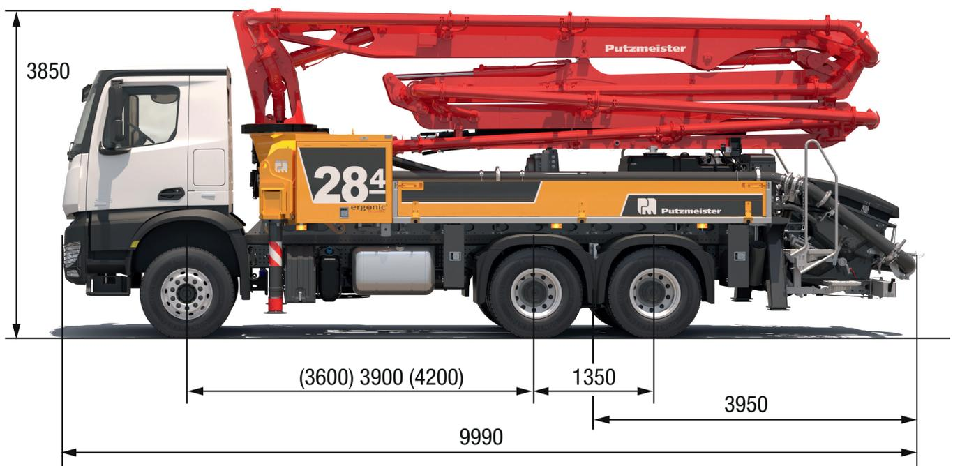
Nota: versione standard. Le dimensioni e il peso variano in base all'autocarro, al modello di pompa e all'attrezzatura.
