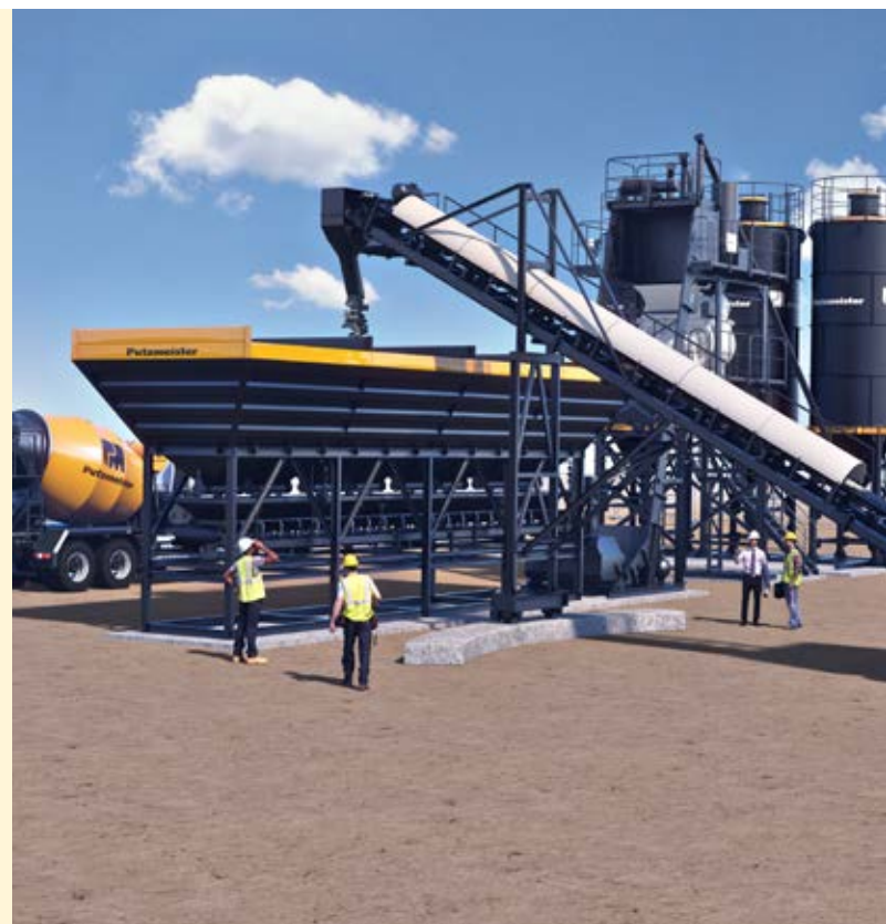
MT 1.0 BANDE DE TRANSPORT INCLINÉE & BACS COMPARTIMENTS
