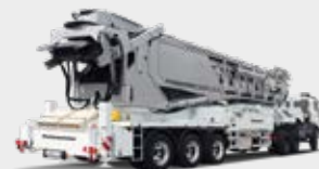
CONVOYEUR MOBILE À BANDE TELEBELT
