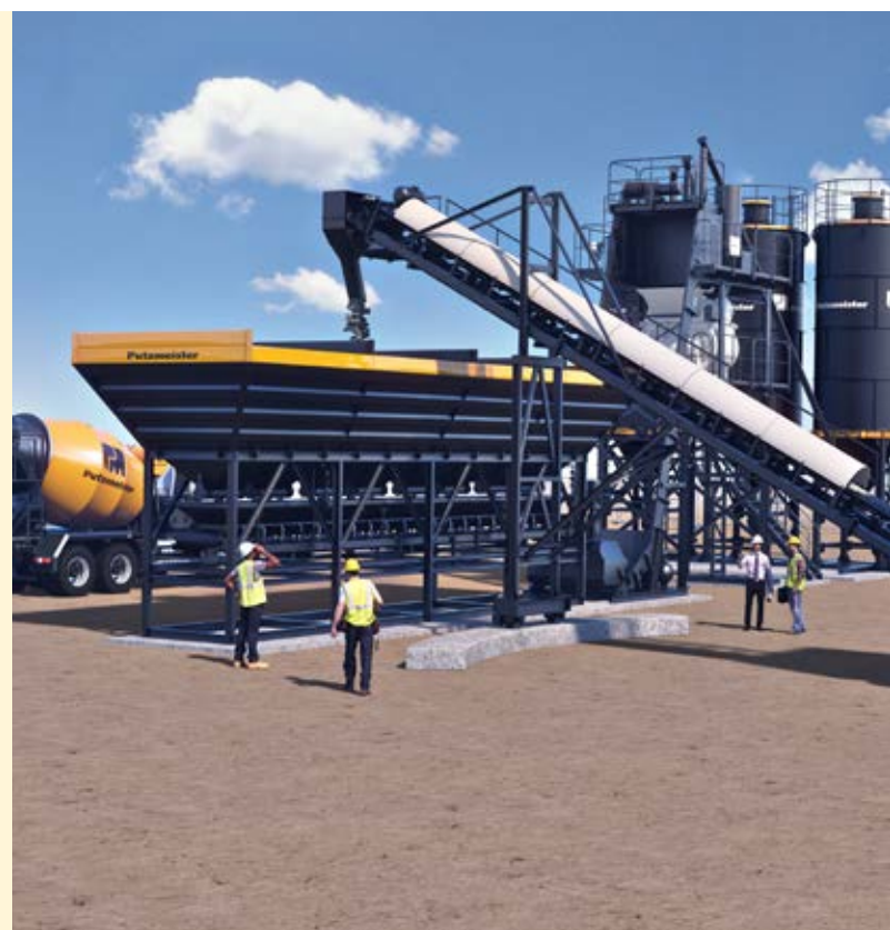
CINTA TRANSPORTADORA INCLINADA Y TOLVAS COMPARTIMENTADAS MT 1.0
