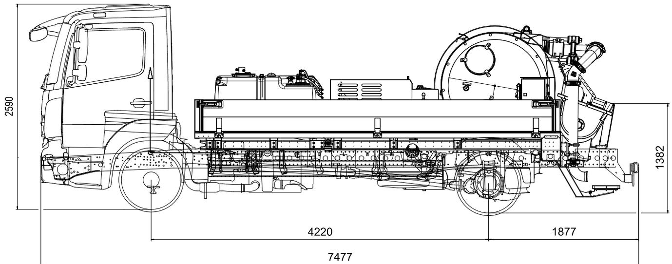
Anmerkung: Standardversion. Abmessungen und Gewichte sind abhängig von Fahrzeug, Pumpenmodell und Ausrüstung.
