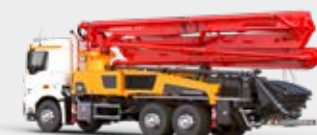
BOMBA DE HORMIGÓN SOBRE CAMIÓN
