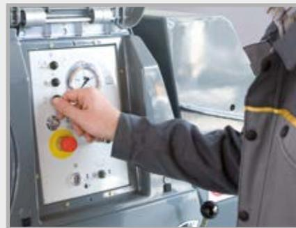
Les instruments analogiques parfaitement lisibles et les commutateurs robustes sont bien à l'abri des salissures et des dommages grâce au solide volet de protection.
