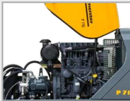
Moteur diesel fiable 3 cylindres refroidi à l'huile Deutz, conforme au règlement sur les émissions d'échappement (Stage 3A).
