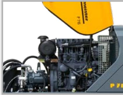
El fiable motor diésel Deutz tricilíndrico refrigerado por aceite (cumple la normativa de emisiones fase 3A).
