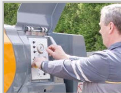
La P 718 se commande entièrement à partir d'un côté, par ex. le réglage en continu du débit de refoulement ou le régime moteur
