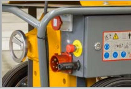
L'armoire de commande centrale fournit également le courant pour des appareils intégrés tels que le malaxeur à axe vertical ou les compresseurs
