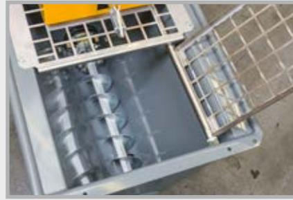
Rejilla de protección con interruptor de seguridad integrado; el ángulo de apertura grande asegura máxima accesibilidad para realizar tareas de conservación y limpieza
