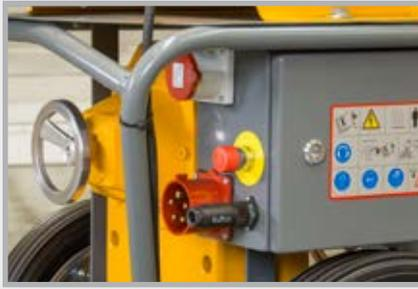
El cuadro de mando central sirve también como distribuidor de corriente para los equipos montados, como mezcladores planetario o compresores
