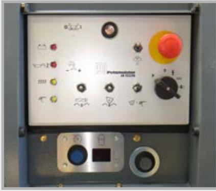
El cuadro de mandos claramente distribuido de la máquina sirve para controlarla de manera sencilla y conforme a la normativa CE. La capacidad de transporte y la dosificación de agua se ajustan sin escalonamientos.
