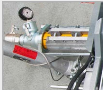
A potente bomba helicoidal 2L6 com uma ligação de pressão M 50 faz parte do equipamento de série. É capaz de processar misturas feitas no local com um tamanho de grão de até 6 mm, dependendo da taxa de distribuição pretendida e das propriedades do material.
