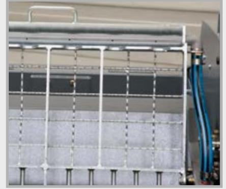
Das intelligent verlegte Wasserdosierrohr verhindert das Verstopfen und die optionale patentierte Staubabsaugung garantiert eine komfortablere Befüllung.
