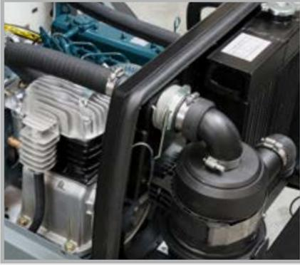
Das extrem leistungsstarke 4-Zylinder-Aggregat ist dank der niedrigen Drehzahl von nur 2.600 U/min und der sehr guten Schallisolierung überdurchschnittlich leise.
