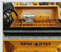
5 Für Spritzbeton entworfener Trichter
