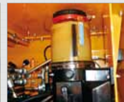
3 Automatische Schmierung der Betonpumpe
