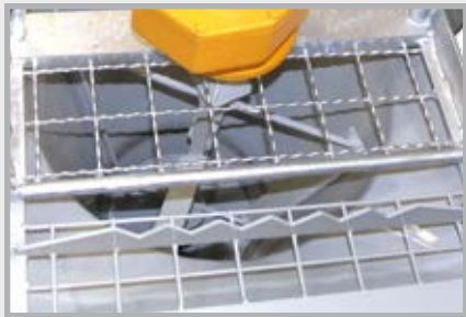
Mezcla bombeo y proyección de una tolva de material
