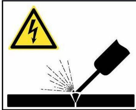
Nos processos de soldadura elétrica, os componentes eletrónicos podem ser destruídos por tensões externas. Por este motivo:
