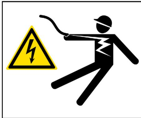
Os componentes da máquina nos quais é necessário realizar trabalhos de manutenção devem ser colocados sem tensão. Proteja os componentes da máquina desligados da corrente para que não possam voltar a ser ligados. Antes de mais, deve verificar se os componentes estão realmente desligados da corrente e, em seguida, ligar à terra, curto-circuitar e isolar peças contíguas que se encontrem sob tensão.
