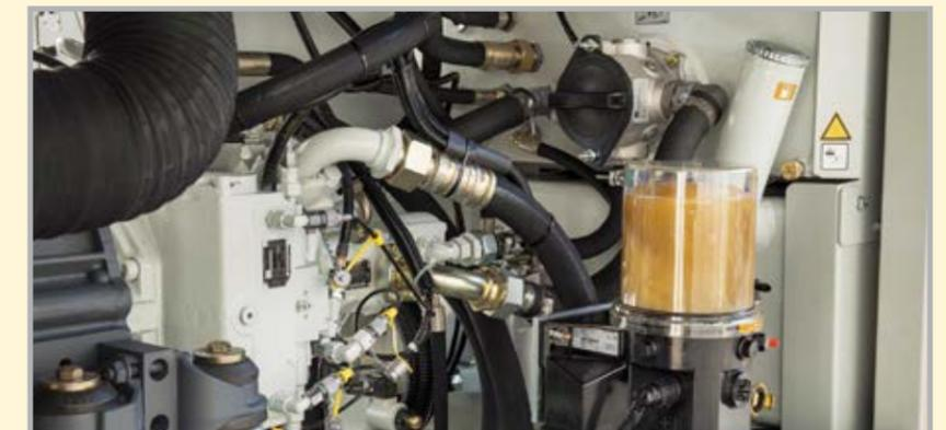
Die elektronische Fettzentralschmierung spart Arbeitszeit und minimiert Verschleiß
