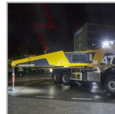
Los puntos de luz para iluminar los 4 puntos de apoyo hacen que la colocación en la oscuridad sea más segura y más rápida
