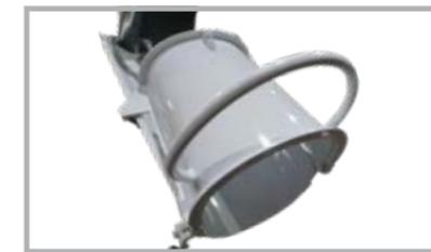
Klappteil mit Schwerkraftsicherung
