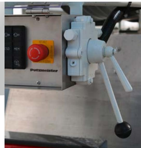
Bedienhebel für Trommelgeschwindigkeit
