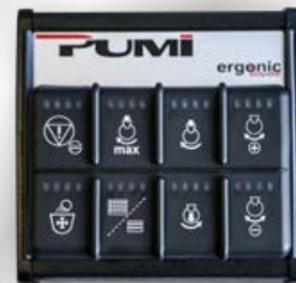
Teclado Keypad en la cabina del conductor
