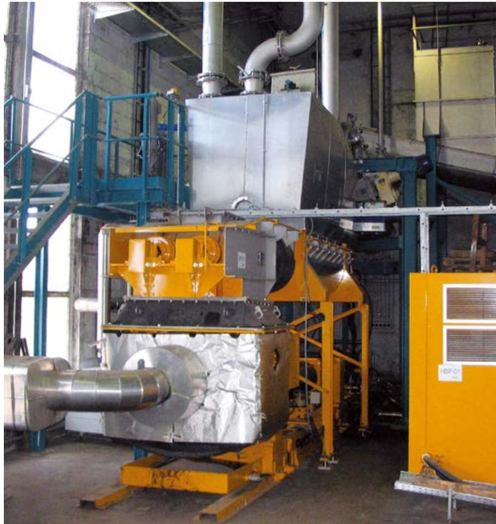
KOS 25100 mit Hydraulikaggregat und Doppelschneckenförderer für den Transport der Biomasse zum Gärtank
