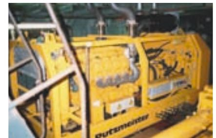
Im Inneren des Pontons montiertes Diesel-Hydraulikaggregat
