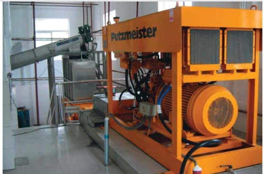
**Rechts:** Hydraulikaggregat HA 132 E
