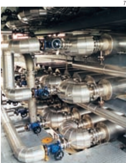
In der Rohrstrecke aus hochwertigem VA-Stahl wird die Rohware in 3 Stufen bis auf die benötigte Sterilisationstemperatur von 138 °C erhitzt
