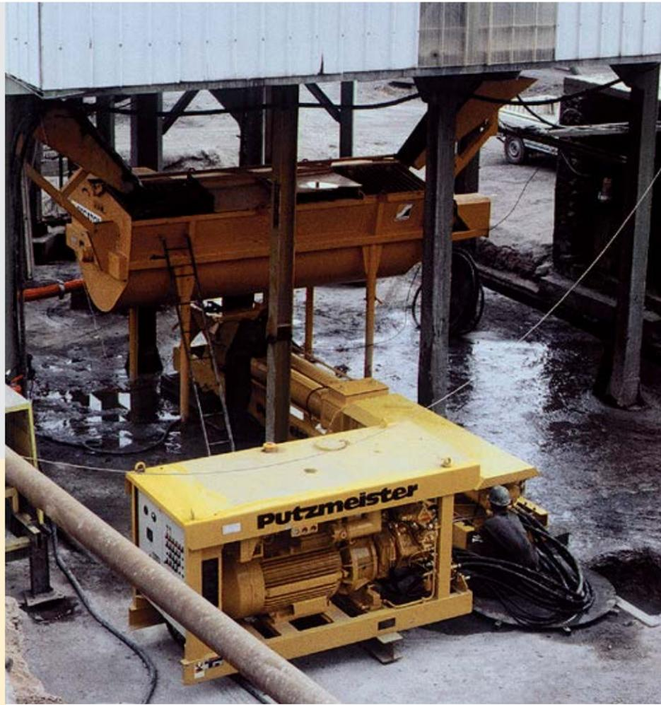
Direkt über der KOS Dickstoffpumpe befindet sich der 12 m<sup>3</sup> fassende Vorratsbehälter. Das Hydraulikaggregat der Dickstoffpumpe ist im Vordergrund.
