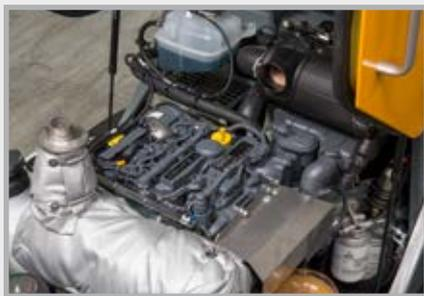
Potencia máxima de accionamiento gracias al motor Deutz de 44,5 kW, que cumple todos los requisitos de la actual norma sobre emisiones „Stage V“.
