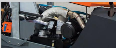
Moteur diesel performant et plus économe en carburant avec un très grand réservoir de 70 l. Le flux d'air optimisé permet de travailler par des températures ambiantes plus élevées jusqu'à 55°C.
